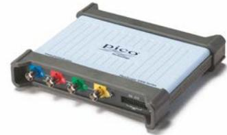
Die Oszilloskope der PicoScope 5000D-Serie mit hoher Speichertiefe verfügen über eine maximale Abtastrate von 1 GS/s, Konnektivität über USB 3.0 und einen Generator für anwenderdefinierte Wellenformen ([AWG](#)) sowie die folgenden Spezifikationen:
