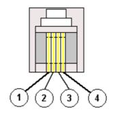
Pin 1 : Signal Input Pin 2 : Ground Pin 3 : Auto Detect Pin 4 : VCC
