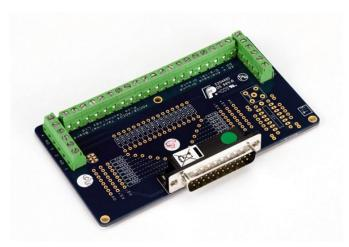
此外, ADC-24 具有四个可配置的数字输入/输出通道, 可用于控制报警或其他设备。ADC-20 和 ADC-24 的灵活性使您可以将这些精确数据记录器用作高级多通道数据采集系统, 从而降低每个通道的成本。
